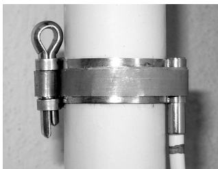
Teplotní čidlo s kontaktní páskou
